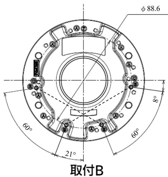
固定ピッチ83.5 mmの穴を使って、カメラを直接本金具に取り付ける場合 (◎の穴)
