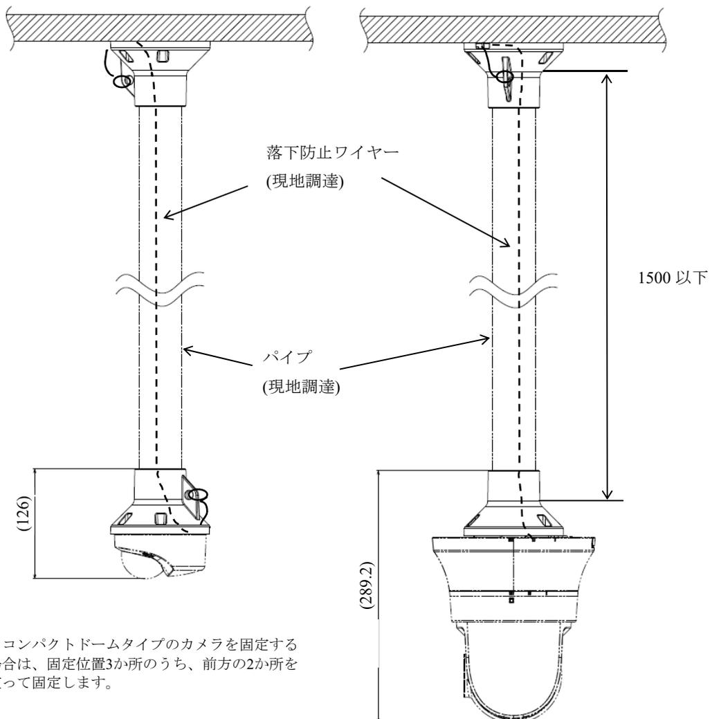
\* コンパクトドームタイプのカメラを固定する場合は、固定位置3か所のうち、前方の2か所を使って固定します。
