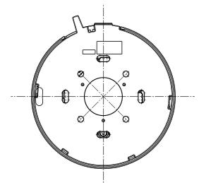
●接続管用めねじは、JIS C 8305 (電線管ねじ) の CTG22 またはJIS B 0202 (管用平行ねじ) の G3/4に対応しています。
